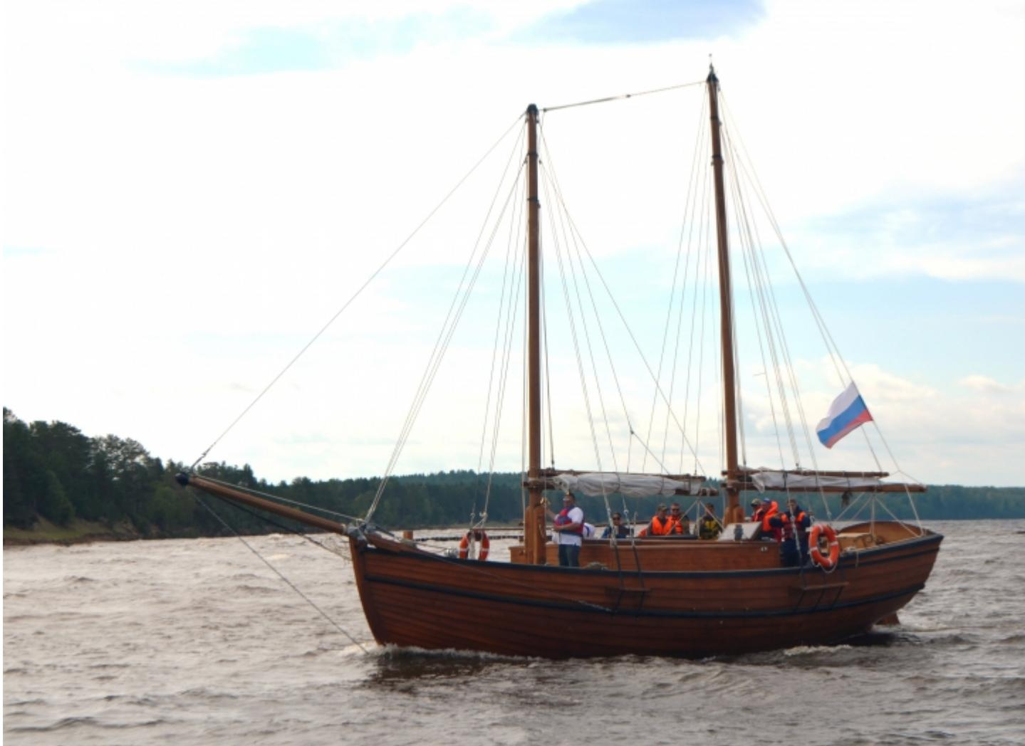
ПАРУСНО-МОТОРНОЕ СУДНО - это парусное судно со вспомогательной механической установкой (двигателем внутреннего сгорания), работающей при безветрии и маневрировании.
